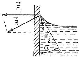
FIG. 143 - La forza  $\vec{F}_1$  di adesione è maggiore di quella  $\vec{F}_2$  di coesione; la risultante  $\vec{R}$  è diretta verso la parete del recipiente e la superficie libera del liquido, normale a tale risultante, è concava (caso dell'acqua contenuta in un recipiente di vetro pulito). L'angolo  $\alpha$ , detto «angolo di raccordo» è acuto.
