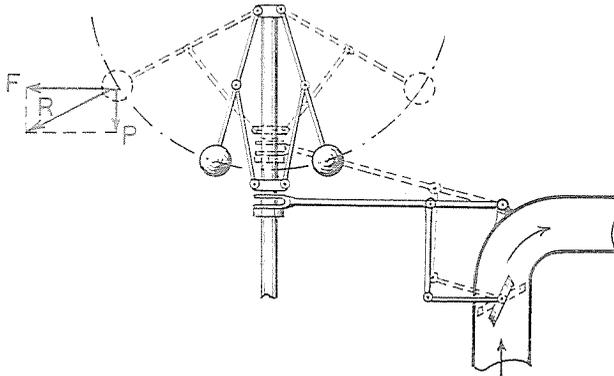
FIG. 107 - Regolatore centrifugo di velocità.
