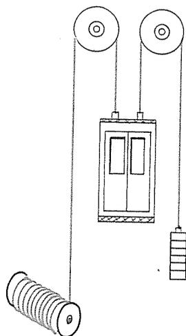
FIG. 76 - Schema di utilizzazione pratica di sistemi di carrucole nell'ascensore.
