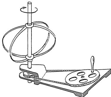
FIG. 101 - Macchina di rotazione.
