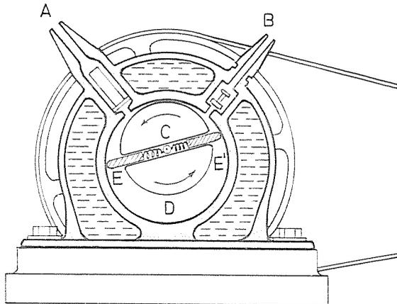
Fig. 173 - Schema di pompa pneumatica rotativa che permette di ottenere rapidamente pressioni dell'ordine di 0,01 mm di mercurio. Nella cavità D un cilindro C, che ruota ad alta velocità attorno ad un asse eccentrico, porta lungo un suo diametro due pistoni mantenuti aderenti alle pareti della cavità mediante una molla centrale. Durante la rotazione l'aria, aspirata attraverso A, viene espulsa attraverso B.
