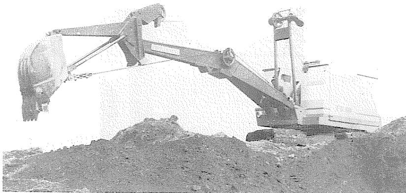
L'insieme di diverse macchine semplici permette la realizzazione di potenti strumenti di lavoro: escavatore Fiorentini, con «cucchiaio» della capacità di litri 800.
