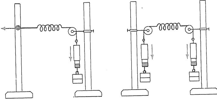
FIG. 88 - Uno stesso peso viene equilibrato indifferentemente dalla reazione del vincolo (disegno a sinistra) e da un ugual peso (disegno a destra).
