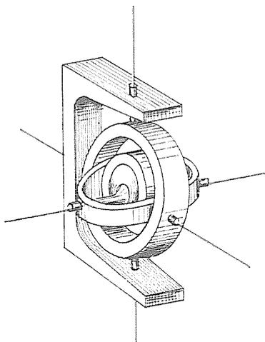
FIG. 115 - Schema di giroscopio con indicazione dei tre assi liberi di rotazione.
