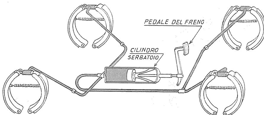
Fig. 125 - Schema di freni idraulici per autoveicoli.
