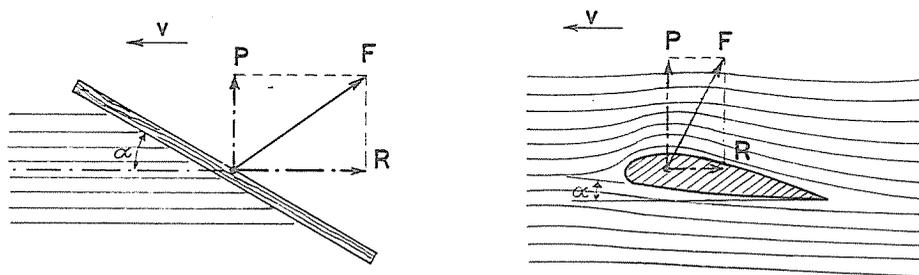
FIG. 176 — Principio di funzionamento dell'ala; nel caso pratico raffigurato nel disegno a destra la particolare conformazione dell'ala e la sua inclinazione fanno in modo che la portanza sia notevolmente maggiore della resistenza.
