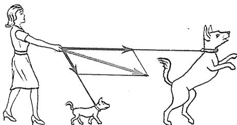
FIG. 33 - Le forze esercitate dai due cani si compongono in un'unica risultante.
