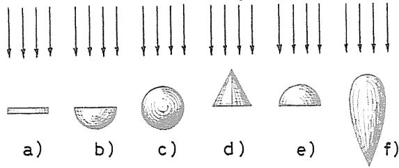
FIG. 119 - Oggetti di ugual sezione presentano resistenze diverse al moto di un fluido a seconda della loro forma: in figura la resistenza risulta decrescente procedendo da a) verso f).
