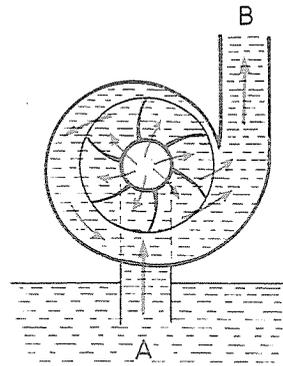
FIG. 106 - Pompa centrifuga.
