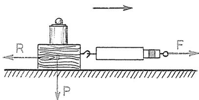
FIG. 118 - Dispositivo per la verifica delle leggi dell'attrito radente.
