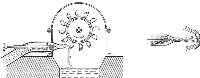
FIG. 168 - Turbina Pelton.
