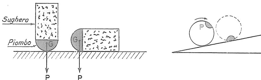
Fig. 59 - Strani effetti nell'equilibrio dei corpi: l'oggetto a sinistra, se inclinato, si raddrizza, quello a destra sale lungo il piano inclinato perché in tal modo, in entrambi i casi, il baricentro si abbassa.
