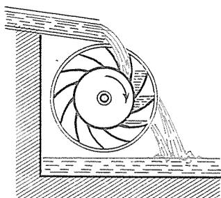
FIG. 167 - Ruota idraulica ad alimentazione superiore.
