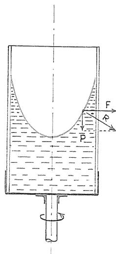
FIG. 127 - Principio di funzionamento di un tachimetro.
