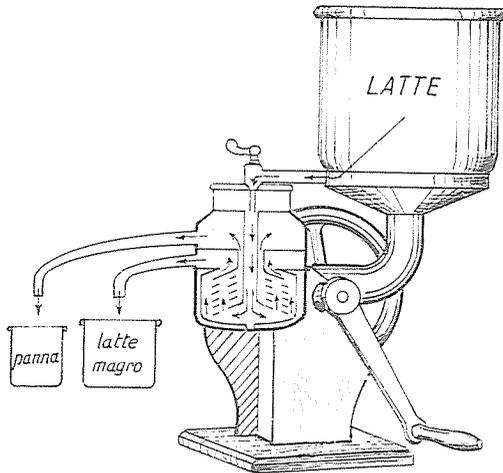
FIG. 105 - Scrematrice centrifuga.
