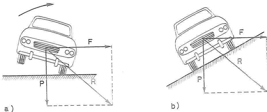
FIG. 104 - La risultante  $R$  della forza peso  $P$  e della forza centrifuga  $F$  nel caso a) cade fuori della base d'appoggio determinando il ribaltamento del veicolo; l'opportuna inclinazione della sede stradale evita tale inconveniente (caso b).
