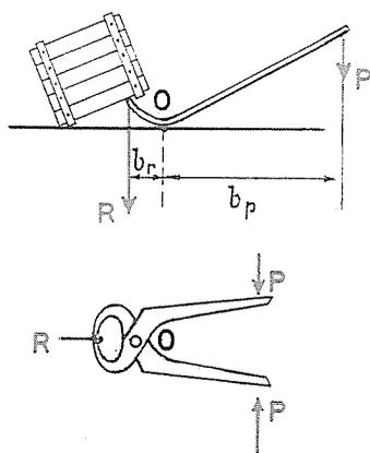
FIG. 63 - Esempi di leve di 1° genere: il palanchino, le tenaglie e la bilancia.
