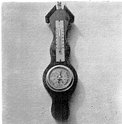
Aspetto caratteristico di un barometro metallico di uso domestico, recante indicazioni dirette di previsione del tempo, accoppiato ad un termometro per la valutazione della temperatura.
