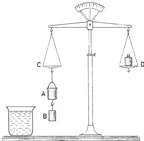
FIG. 149 - Bilancia idrostatica.
