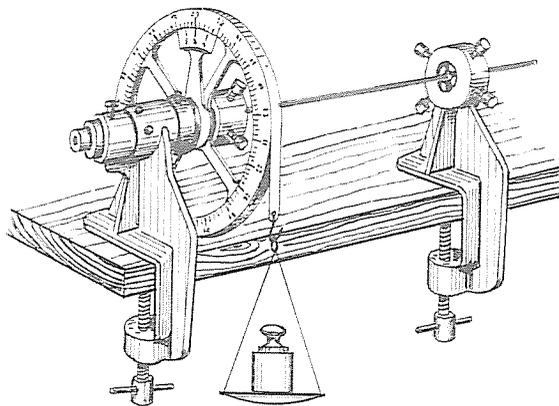
FIG. 123 - Dispositivo per determinare sperimentalmente il modulo di torsione di una sbarra.
