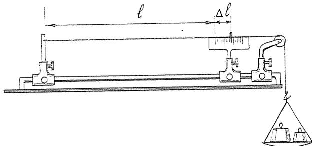
FIG. 120 - Dispositivo per determinare sperimentalmente il modulo di elasticità di trazione relativo ad un filo.
