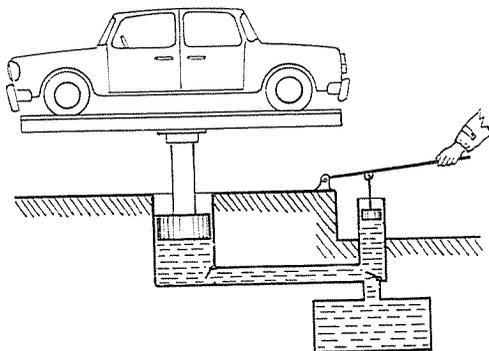
FIG. 130 - Il torchio idraulico impiegato come elevatore.
