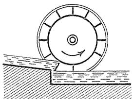
FIG. 166 - Ruota idraulica ad alimentazione inferiore.
