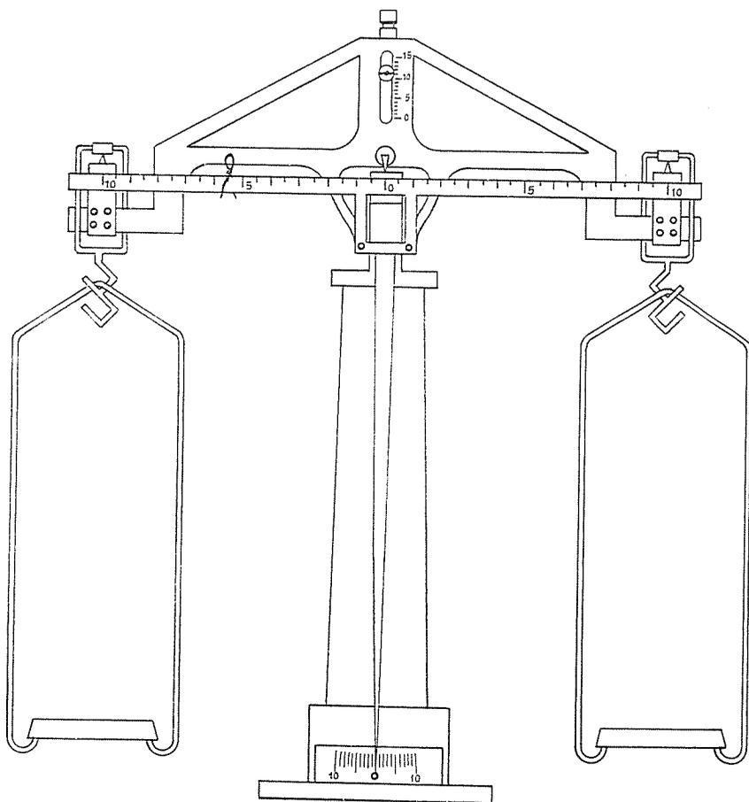
Fig. 67 - Schema di una bilancia di precisione.
