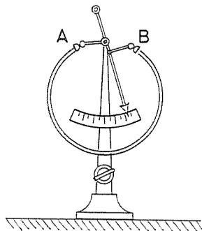
FIG. 156 - Barometro tubolare.
