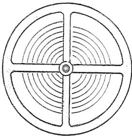
FIG. 99 - Nei comuni orologi viene utilizzato, in luogo del pendolo, un « bilanciere », le cui oscillazioni sono dovute ad una molla a spirale.
