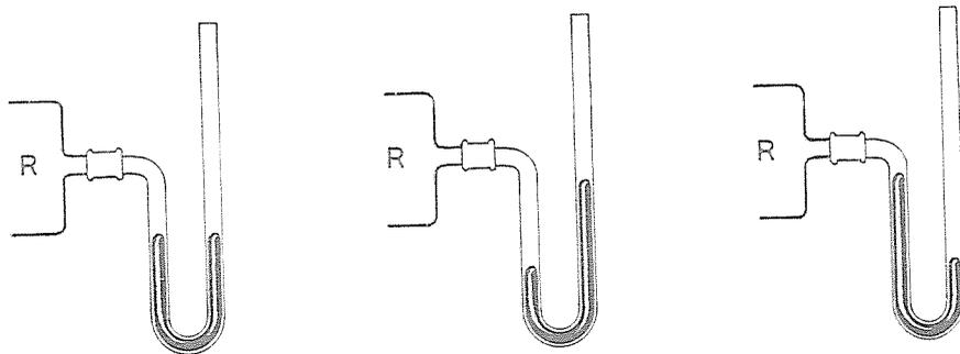
FIG. 160 - Principio di funzionamento di un manometro ad aria libera.
