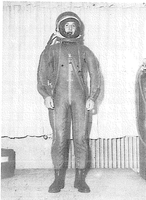
Tuta «anti-g» per piloti ultrasonici: quando il corpo del pilota è assoggettato a forti accelerazioni, un opportuno dispositivo provvede a gonfiare automaticamente sacche distribuite lungo il corpo in modo da impedire, con la loro compressione, pericolosi spostamenti di organi interni ed anormale afflusso del sangue verso le estremità (Aeronautica Militare).
