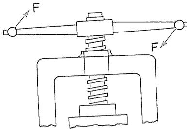
FIG. 43 - Una coppia di forze determina la rotazione dell'asta superiore del torchio.
